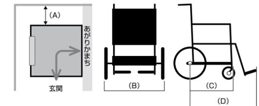
設置したときのすき間(A)が20cm以上ある場合は、後輪の幅(B)が50cm以内、後輪のセンターと前輪の軸部までの距離(C)が55cm以内のものを使用してください。
